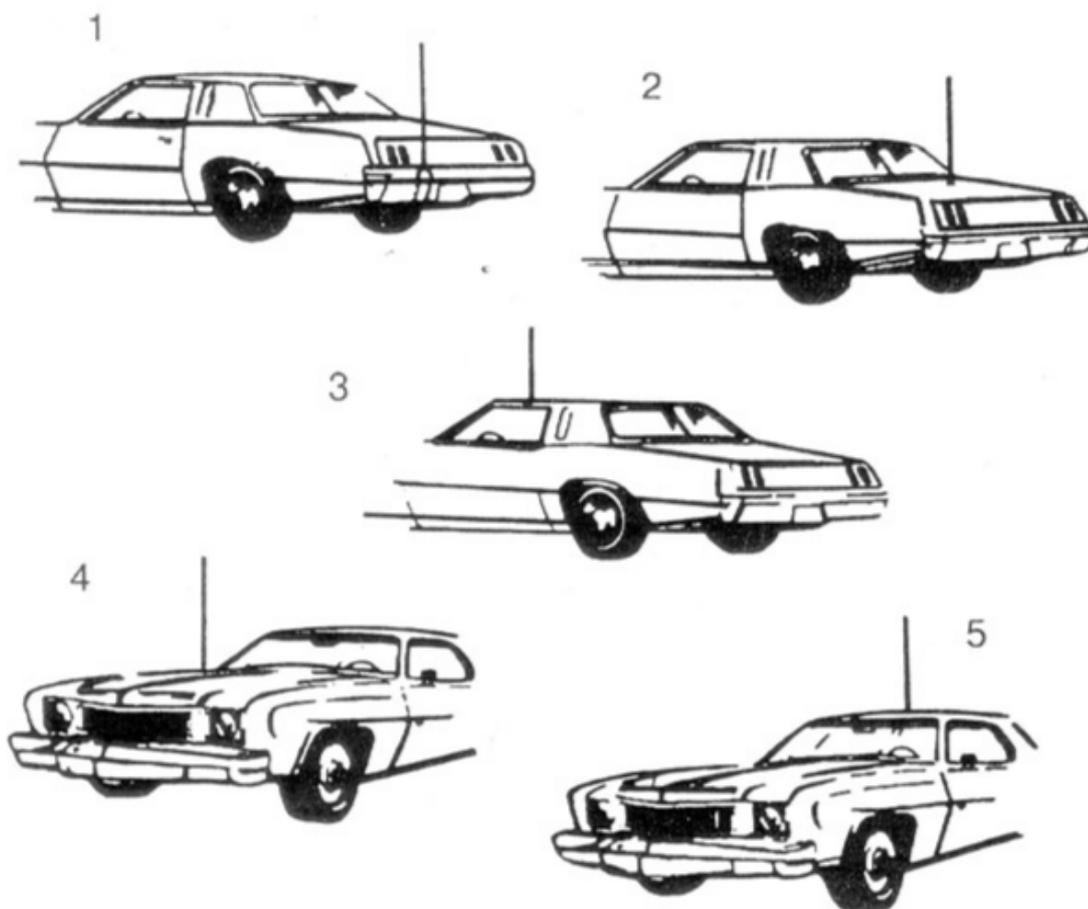
Рис. 6. Типичные места установки автомобильных антенн.
