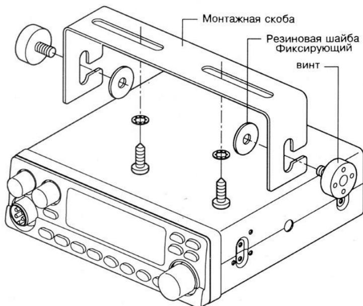
Рис.2. Пример крепления радиостанции при помощи монтажной скобы.
